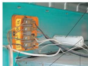
سیم رابط سیم آب خازن اصلاح ضریب قدرت کابل رابط سه سیمه موتور دو دور
