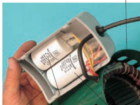
خازن ۱۴ میکروفارادی سرعت زیاد خازن ۹ میکروفارادی سرعت کم درپوش خازن ها
